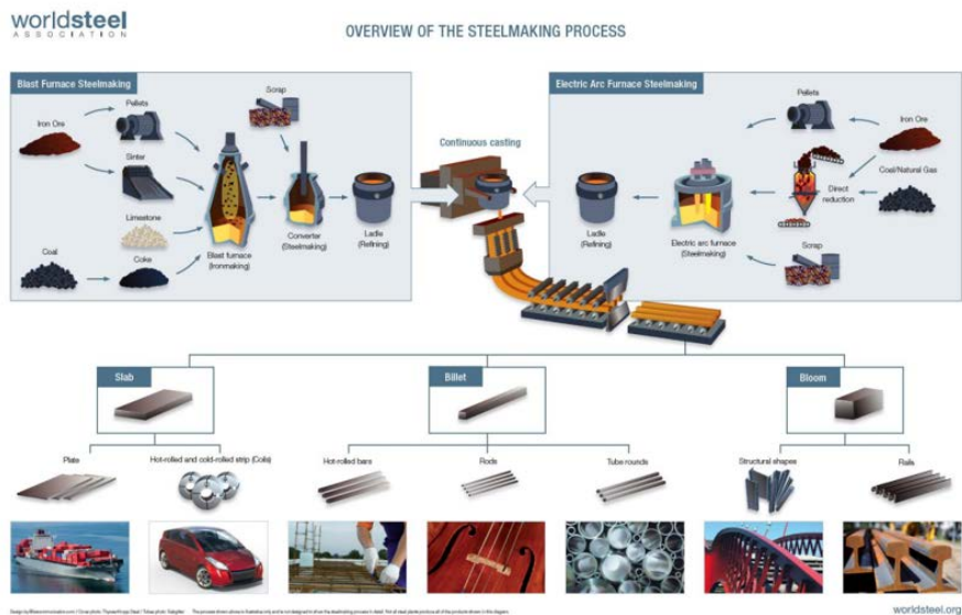
Figura 9 Overview del processo BF+BOF e DRI+ EAF nella produzione di acciaio primario.
