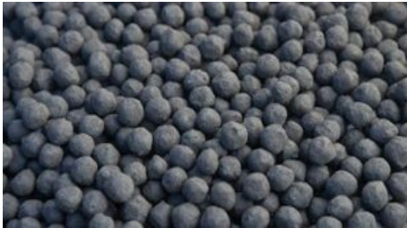
Figura 24 Minerale in pellets da alimentare al forno DRI [22]
